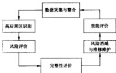
图 1 完整性管理工作流程
